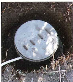
簡易振動センサー (埋設状況)
